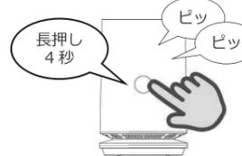
タッチパネル操作部を長押し（約 4 秒）すると、2 回目の“ピッ”という音で運転を停止します。※1 回目の“ピッ”で指を離さないでください（首振り動作/停止となります）。
