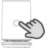
タッチパネル操作部にタッチする度に風量が一段階ずつ増加します。最大の【9】の状態タッチすると、【1】になります。
