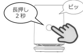
タッチパネル操作部を長押し（約 2 秒）すると、“ピッ”という音と共に首振り動作します。もう一度長押しすると首振り動作を停止します。
